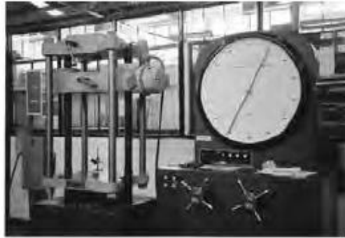
Prueba de tensión:
