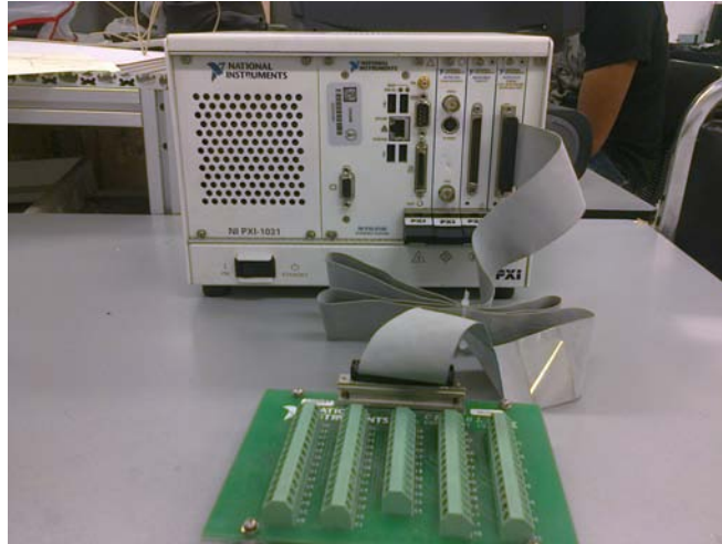
Figura 4.16: PXI y modulo de adquisición de datos con su correspondiente bloque conector.
