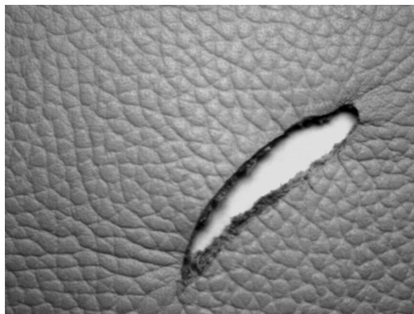
Figura 5.1: Muestra 1 con defecto para el entrenamiento del NI training texture .
