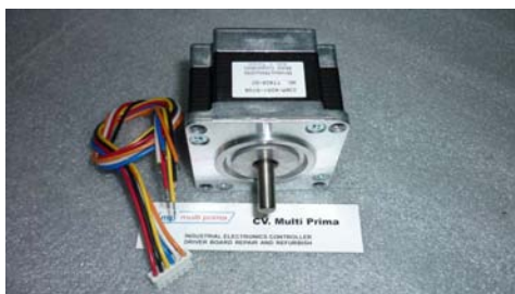
Figura 4.13: Motor Minebea 23KM-K.
