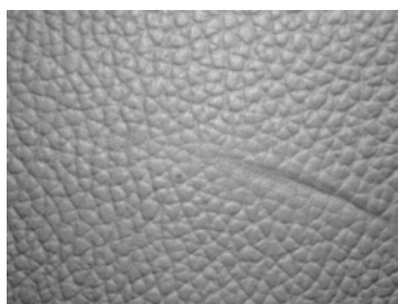
Figura 5.35: Defecto proveniente de la piel curtida No5 que no fue detectado por el algoritmo.
