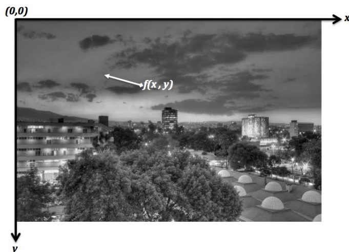
Figura 1.1: Convención de ejes utilizado para la representación digital de imágenes. *Elaboración propia (Julio-2012)
