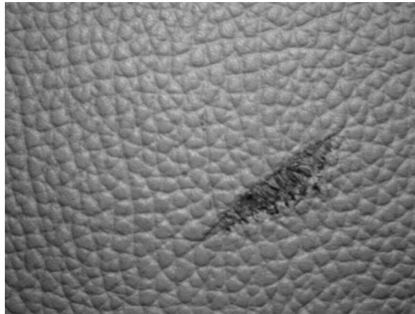
Figura 5.4: Muestra 2 con defecto para el entrenamiento del NI training texture .
