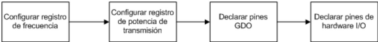
Figura 4.5 Algoritmo de programación de la librería del CC110L
