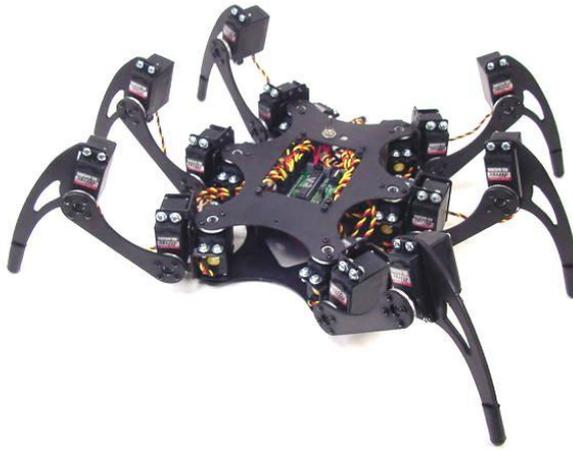
Figura 2.1 Robot Phoenix Lynxmotion hexápodo
