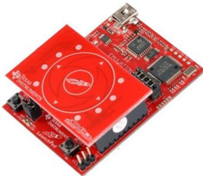
Figura 3.2 *Capacitive Touch BoosterPack* montado sobre *Launchpad*
