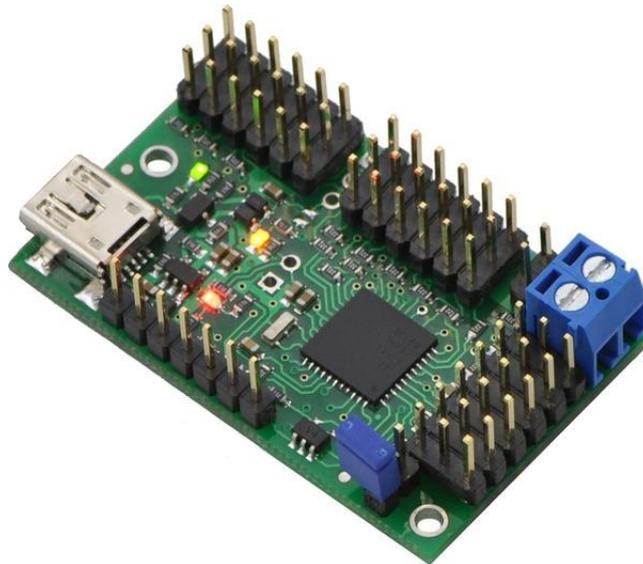
Figura 1.6 Controladora de servomotores Pololu 18 ch
