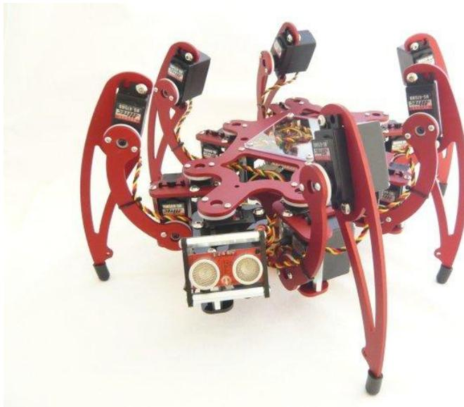
Figura 2.2 Robot hexápodo MSR-H01
