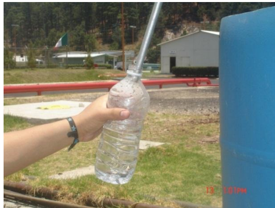
Ilustración 13. Se muestra el momento a la hora de obtener las muestras del condensado para la obtención del gasto másico.
