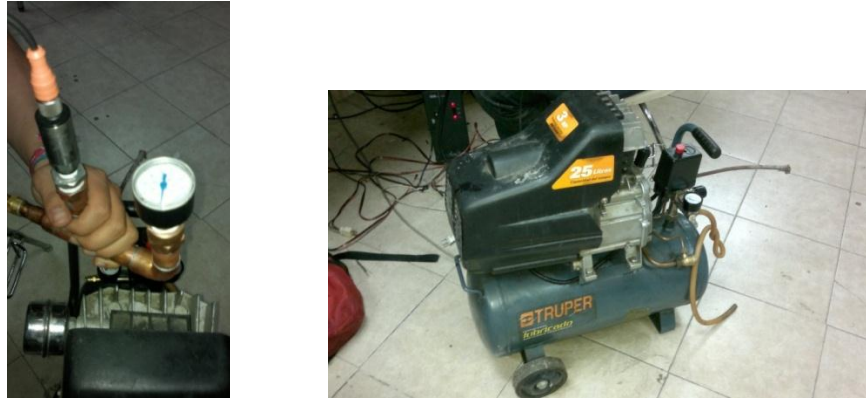
Ilustración 28. Uso de un compresor para el acondicionamiento del sensor.
