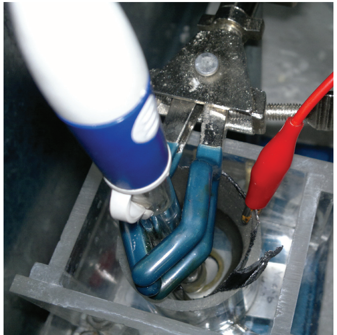
Fig. 2.5. Celda electroquímica para ensayos de impedancia electroquímica
