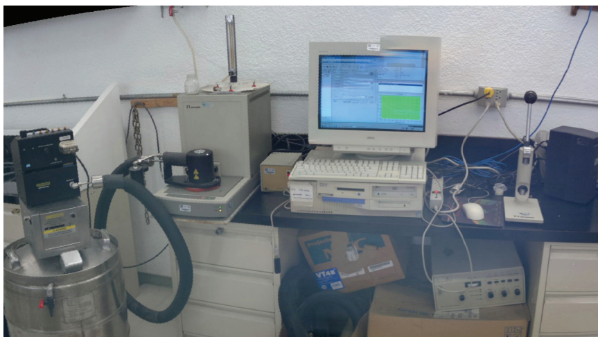
Figura 2.9. Equipo de calorimetría diferencial de barrido del Instituto de Ciencias Nucleares, UNAM.
