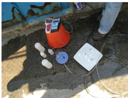
Figura 10. Celda de Aislamiento y dispositivos eléctricos para la medición de diversos parámetros físicos del agua.
