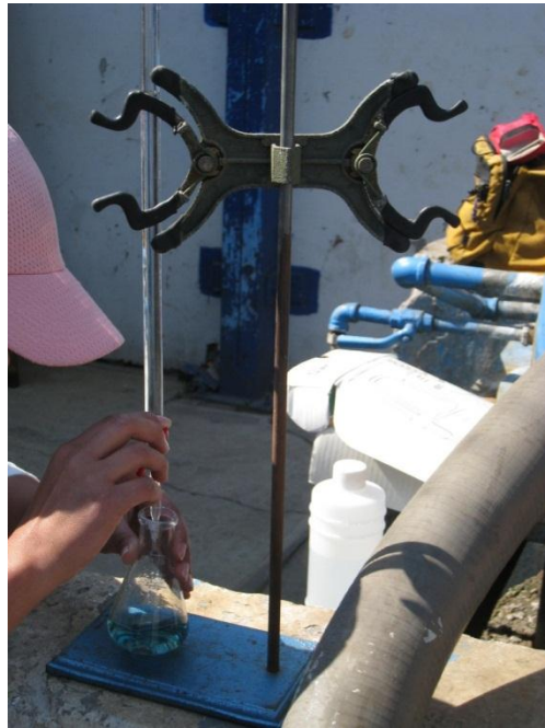
Figura 11. Análisis de la alcalinidad del agua.
