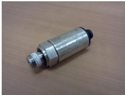
Figura 20. Sensor de presión Mod. 8314.
