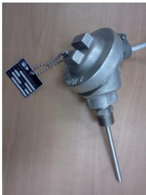
Figura 19. Sensor de temperatura tipo RTD.
