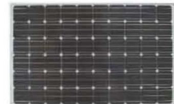
*Luminaria tipo Poste con panel fotovoltaico de 72 células de silicio policristalino de 156 x 156 mm con 15.6% de eficiencia, conexión serie asegurando la máxima potencia en cualquier situación. Eficiencia final de módulo 13.5%.*
