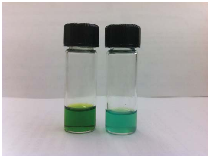
Figura 33. Disolución de H_2TPP en medio de Bu_4NPF_6 0.1 M/ CH_2Cl_2 de: A) después de la electrooxidación y B) en presencia de 2 equivalentes de HClO_4 .
