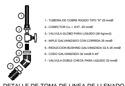
DETALLE DE TOMA DE LINEA DE LLENADO
