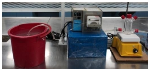
Figura 5-4 Reactor de coagulación
