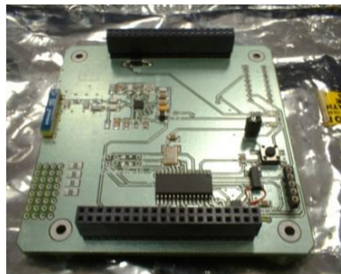
Figura 1.11. Subsistema de Comunicaciones de SATEDU.
