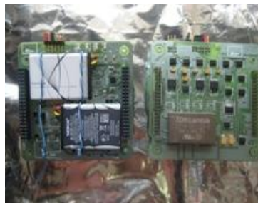
Figura 1.9. Subsistema de Potencia.
