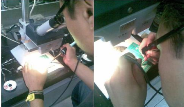
Figura 6.13. Montaje de FPGA en la tarjeta de circuito impreso usando microscopio.
