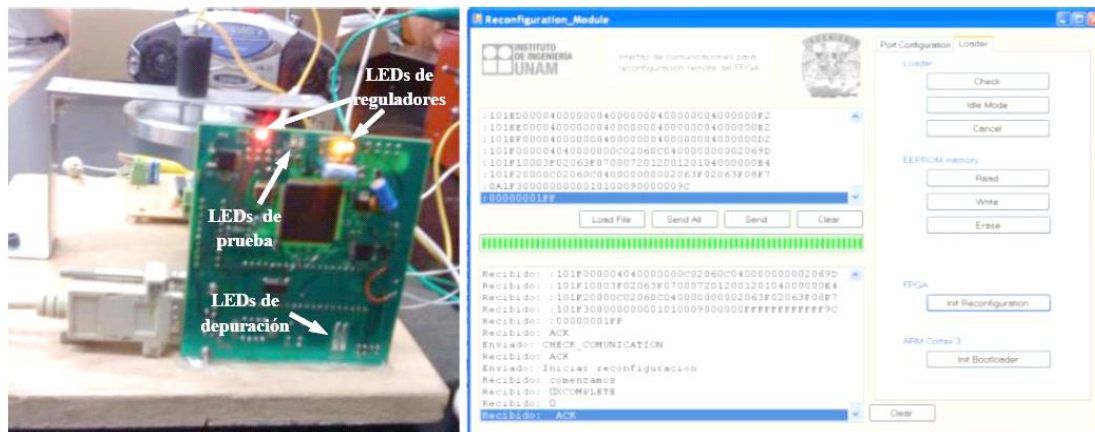
Figura 7.17. Proceso de reconfiguración del FPGA de SMIN de manera alámbrica utilizando al MCU.
