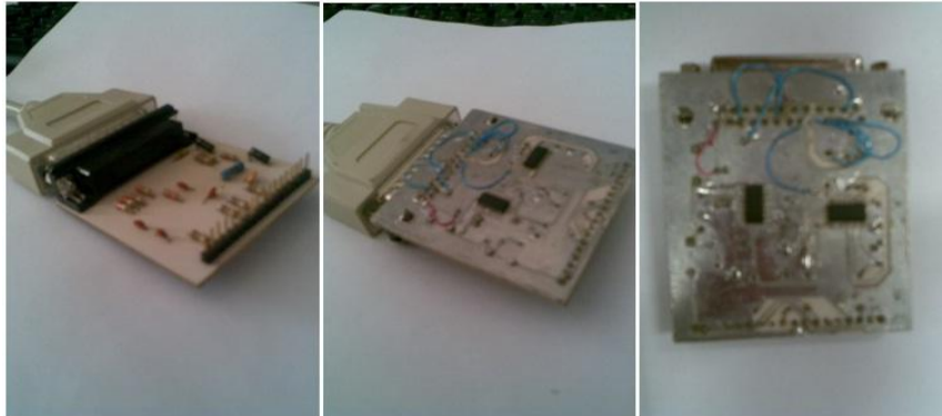
Figura 6.7. Versión propia del cable DLC5.
