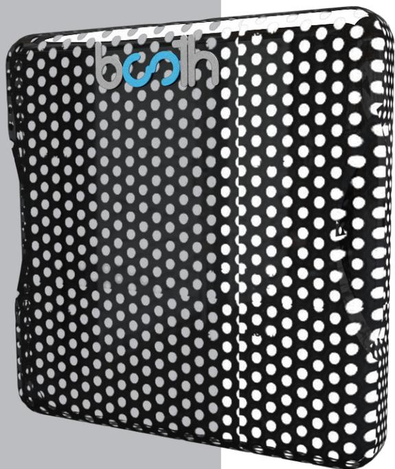
A continuación se describen los sistemas de cierres y carcasa. La bocina tiene en la parte frontal una rejilla de lamina multiperforada troquela calibre 20, la cual permite la salida de las ondas sonoras hacia el publico destinado, esta bordeada para el ensamble y estructuración de la misma, tiene una pequeñas hendiduras para rigidizar y componer la línea de diseño.
