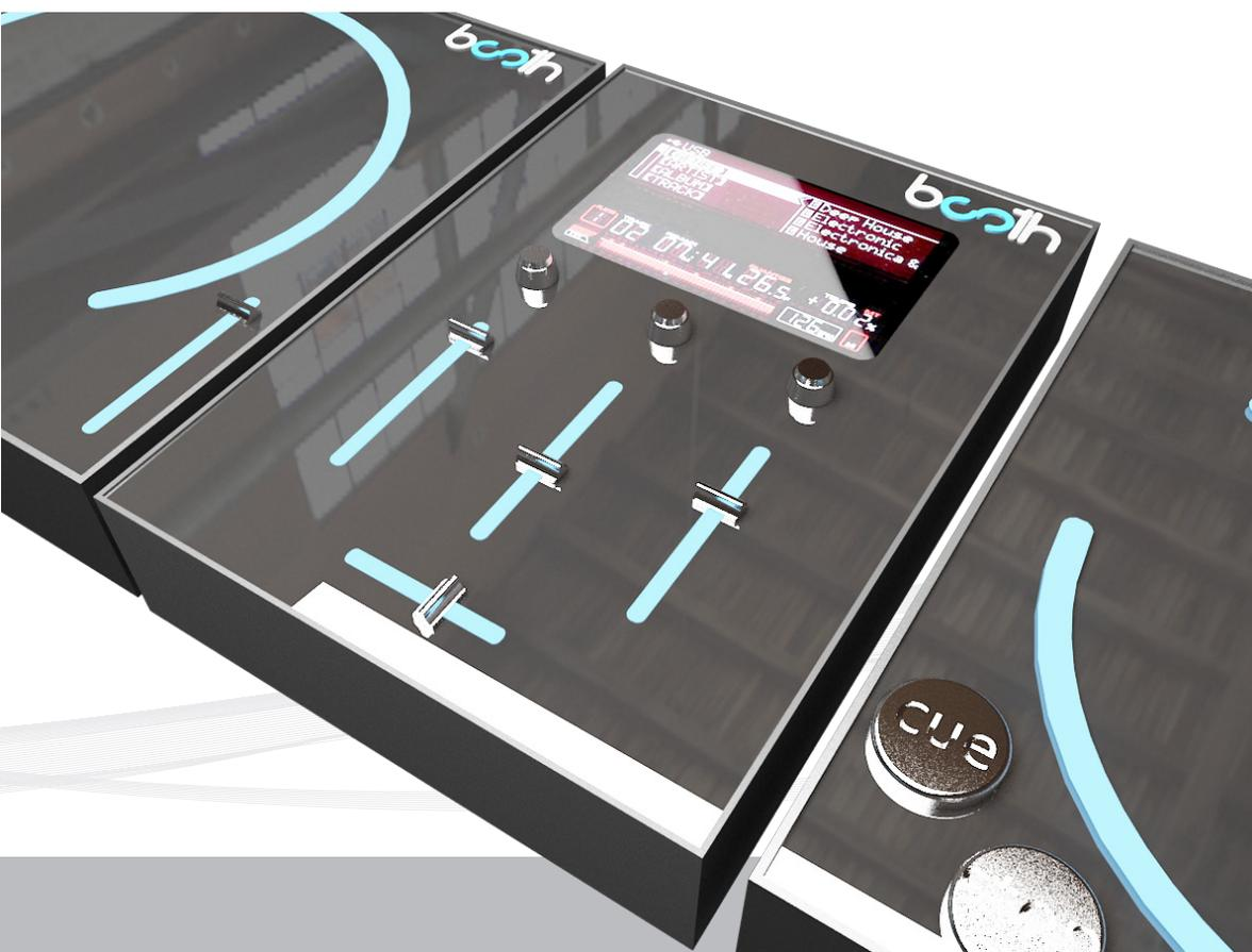
De la mezcladora también está agregado el amplificador de 400 Watts, suficiente para alimentar los altavoces, el amplificador está conectado con las ganancias directas para no tener que manejar volúmenes independientes. La pantalla es touch simple con botones básicos solo de navegación para poder elegir los comandos y manejarlos con las perillas.
