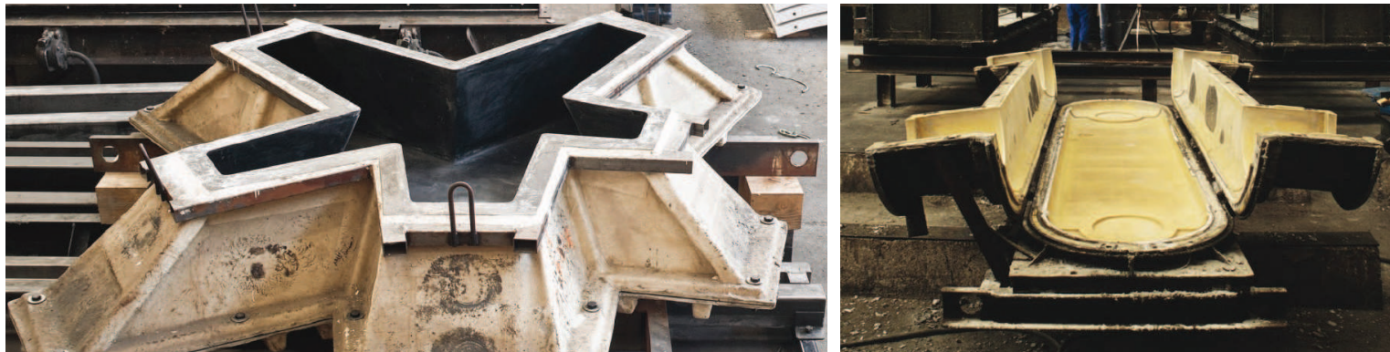
Moldes de Fibra de vidrio y metal para vaciado de concreto. Imágenes cortesía de ESCOFET
