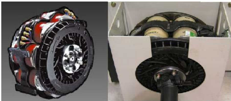
Figura 6 Freno de corrientes parásitas o freno de corrientes de Eddy
