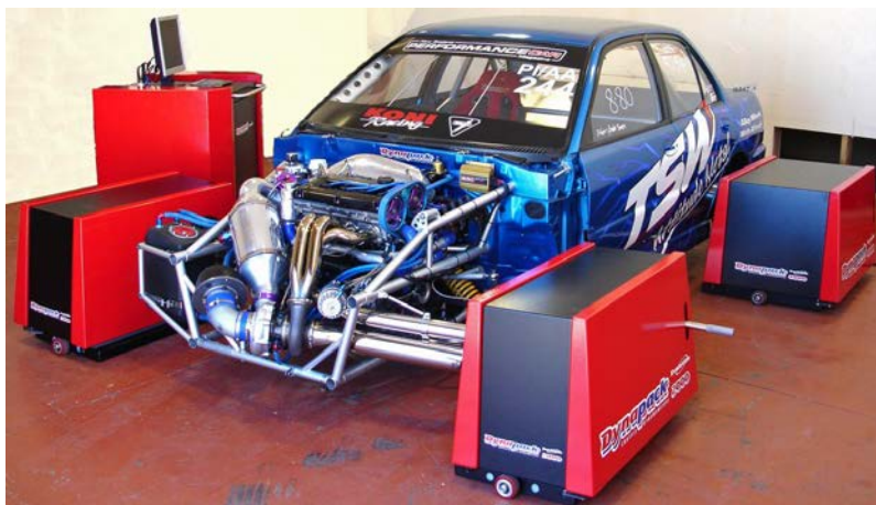
Figura 2.4 Dinamómetro de chasis fabricado por la empresa Dynapack, el cual se acopla a las masas del vehículo evitando así el uso de rodillos y los inconvenientes asociados al uso de estos.
