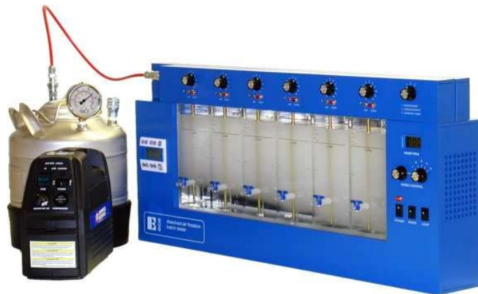
Figura 4.3 Equipo de pruebas de coagulación-floculación con flotación con aire disuelto
