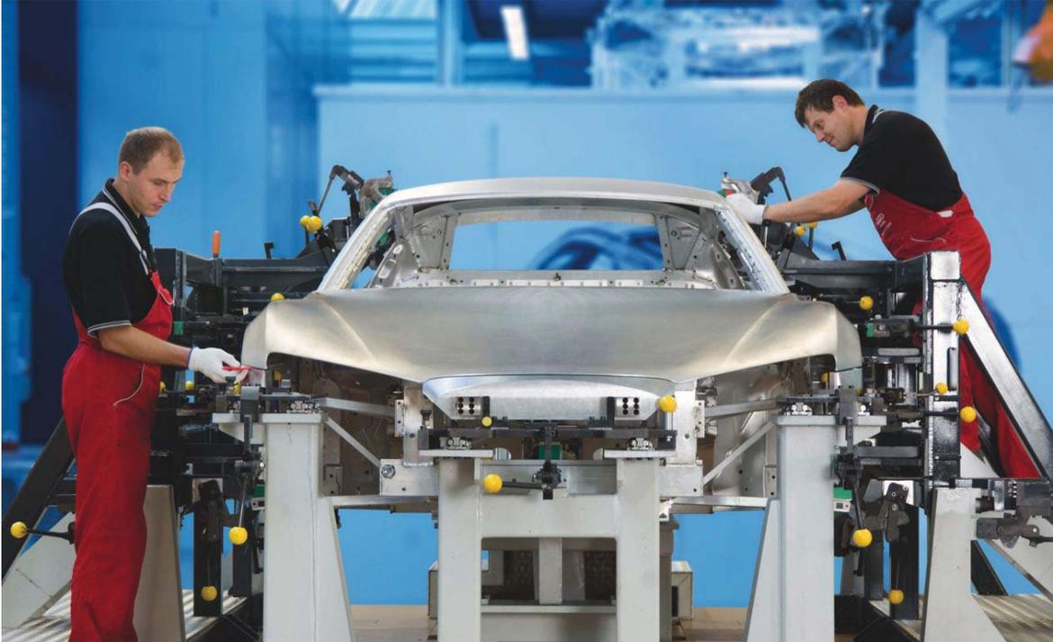
Arriba. El Audi R8 usa tecnología de hidroformado para conformar su chasis y carrocería.
