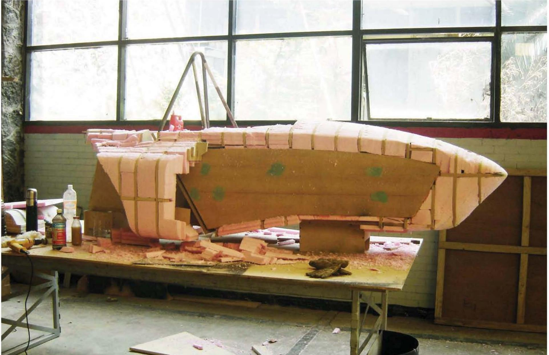
se planteó entonces como un diseño independiente, resuelto para generar un seccionamiento preciso de las superficies de la carrocería y de los detalles de empaquetamiento, generando ensambles precisos entre piezas dependiendo de su ubicación y características específicas, gracias al uso de tecnología CNC para su corte y al haber sido diseñada como un mueble para asegurar su integridad y fuerza estructural.
