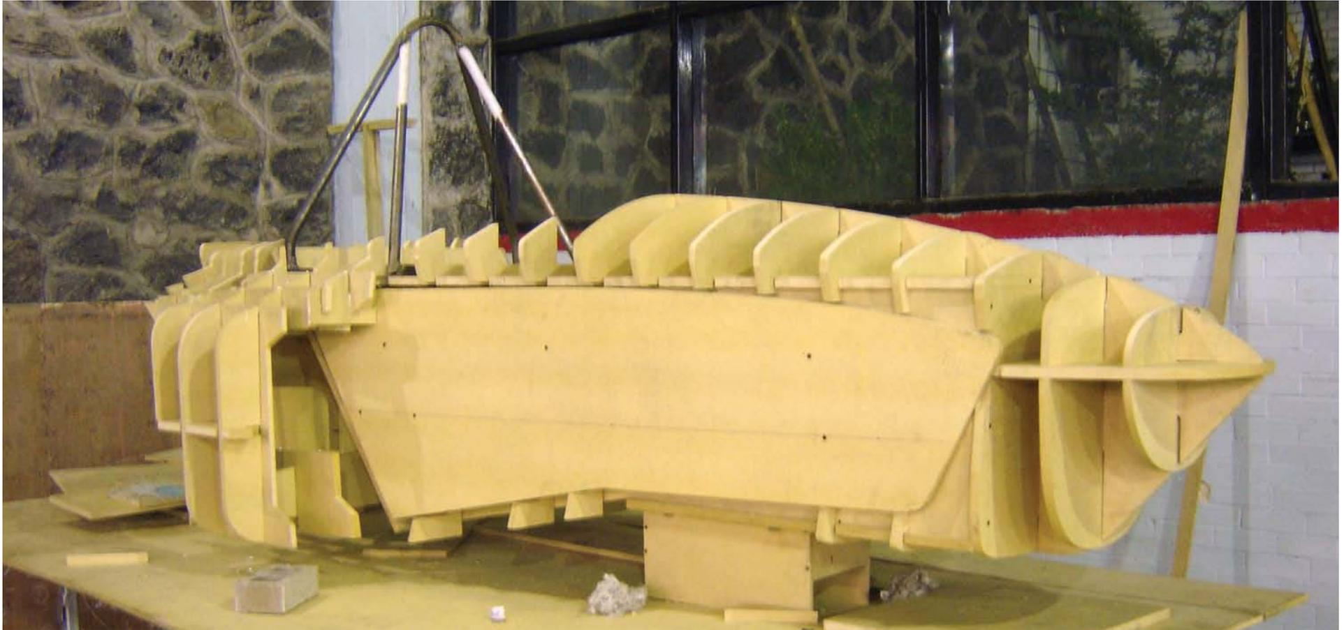
Arriba. Estereotomía armada lista para el proceso de relleno de espacios entre secciones.
