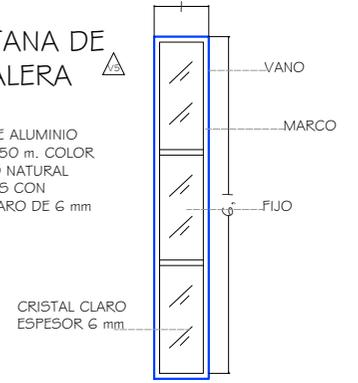
PUERTA DE ALUMINIO DE 2.1X.60 m. COLOR ANODIZADO NATURAL CON 2 FIJOS CON JALADERA Y CRISTAL CLARO DE 6 mm
