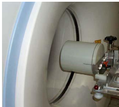
Figura A1. Colocación del maniquí de ^{18}\text{F} en el equipo PET/CT para realizar la “calibración cruzada”
