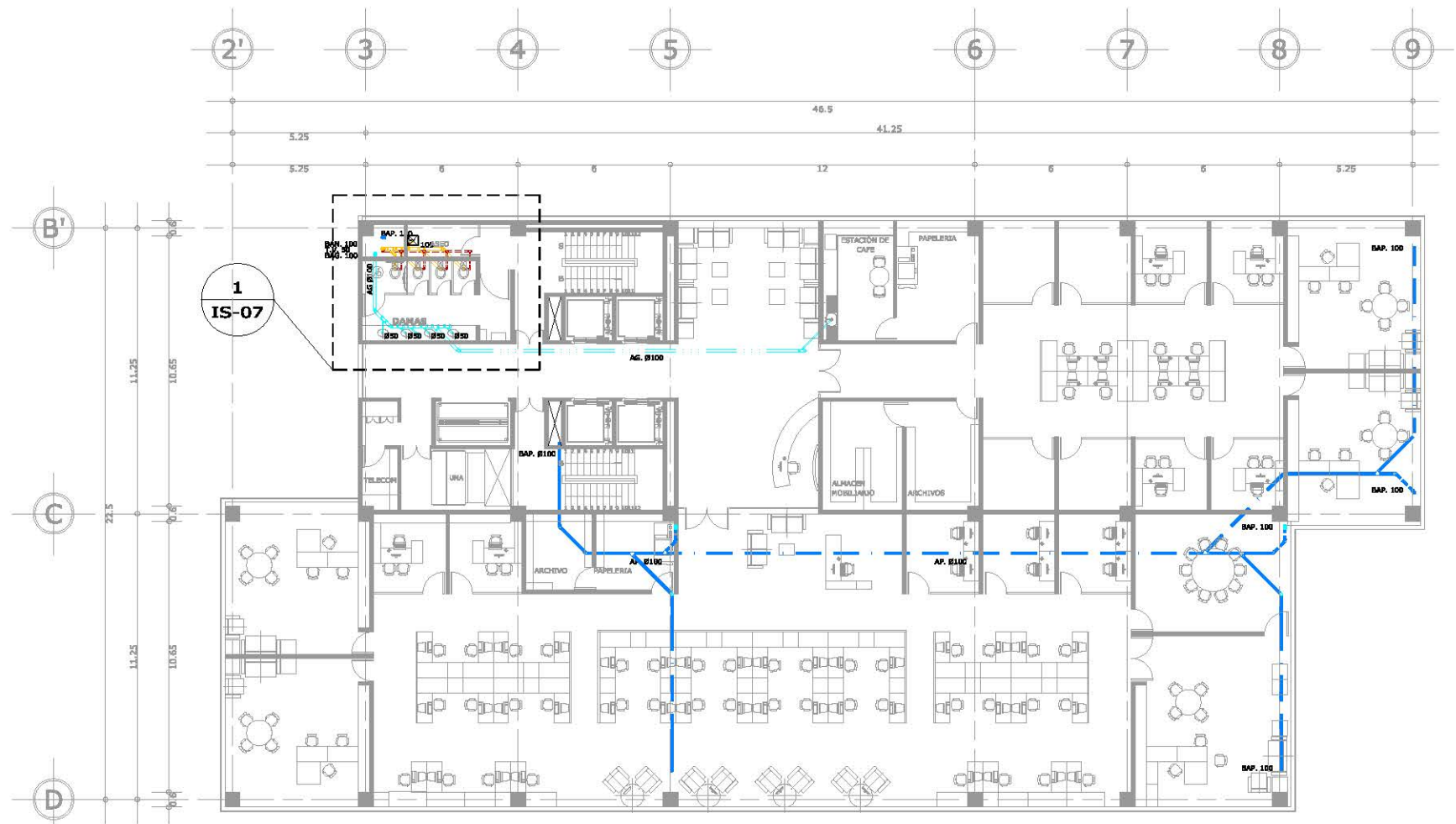
INSTALACION SANITARIA - PLANTA TIPO A ESD. 1:250
