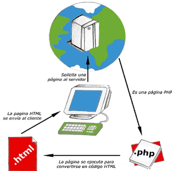
Figura 3.6 Funcionamiento del PHP
