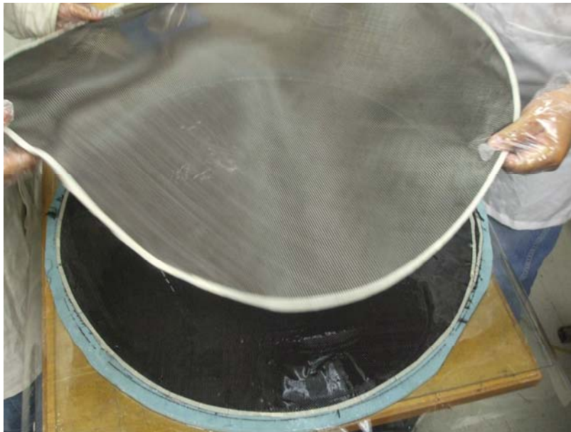
Figura 2.3 Plataforma construida con fibras de carbono.
