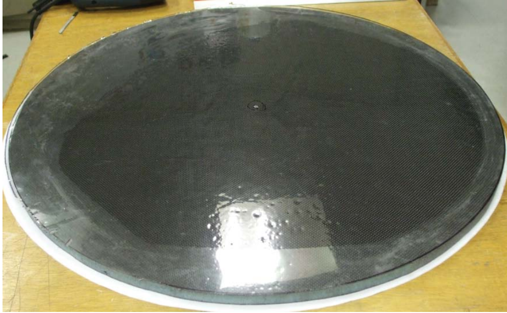
Figura 3.10. Panel de fibra de carbono y epoxy, después de la primera etapa de maquinado y sellado del borde.
