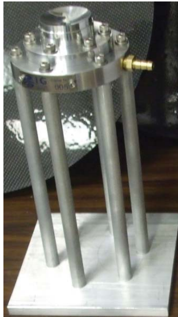
Figura 3.6. Todas las piezas que conforman el cojinete neumático esférico y la base de la plataforma.
