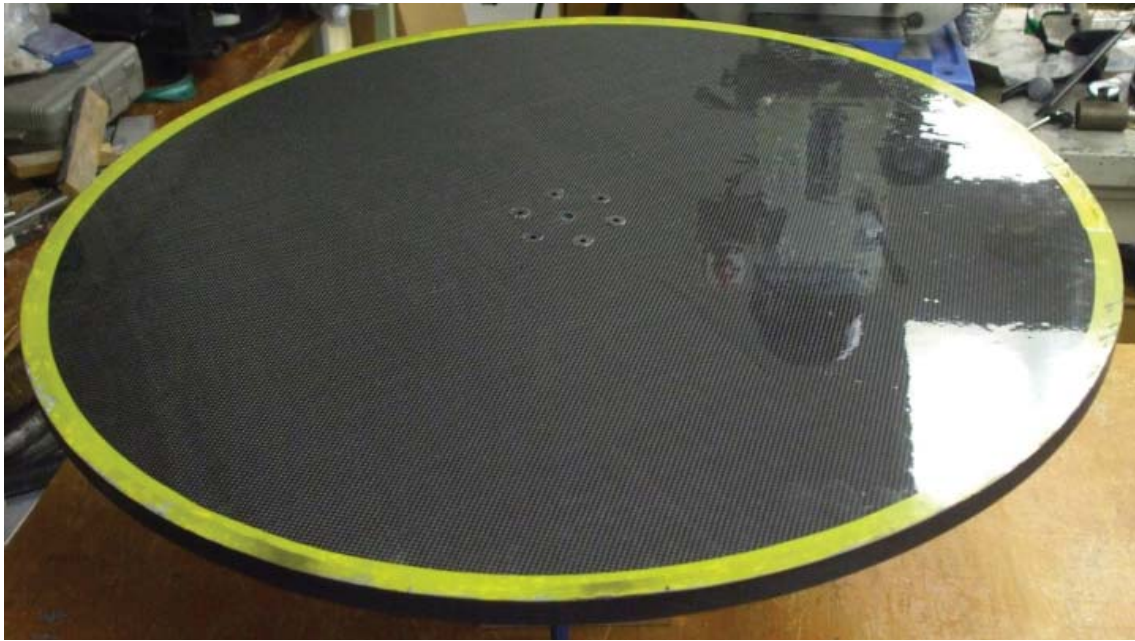
Figura 3.11. Plataforma terminada. Se aprecian los tornillos que la unen al cojinete neumático esférico.
