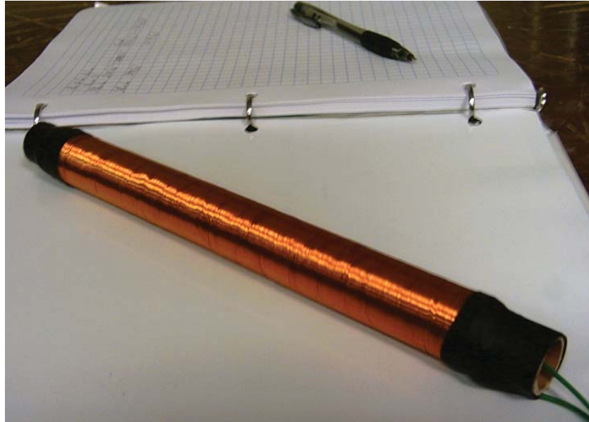
Figura 4.1. Imagen de la bobina de forma tubular, con núcleo de ferrita.
