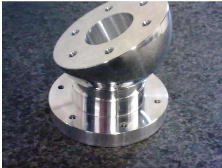
Figura 2.2. Semiesfera y copa, partes fundamentales de un balero de aire esférico
