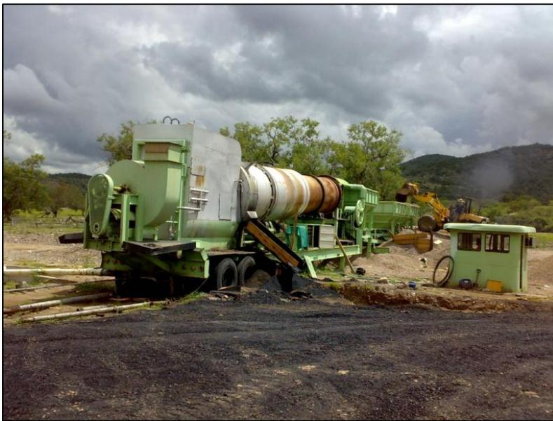
Producción de material de carpeta asfáltica en planta.
