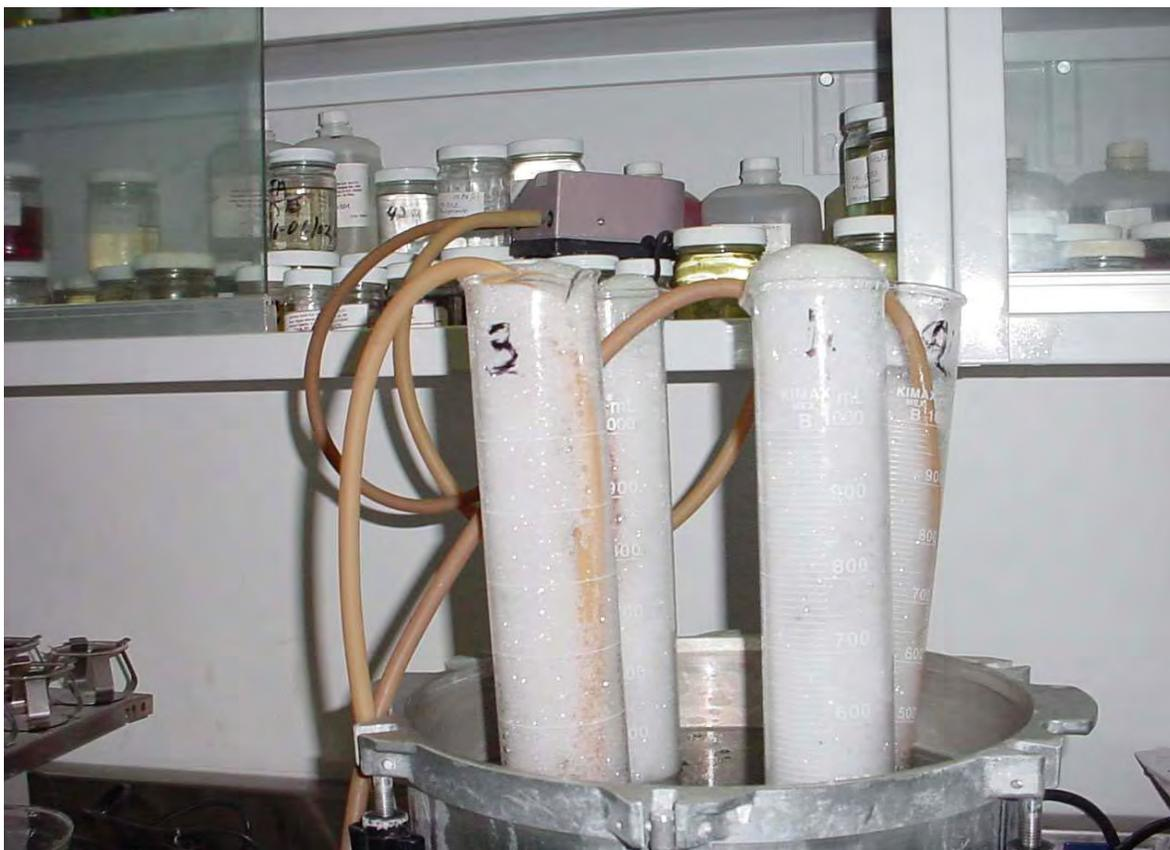
Imagen 5-1 La muestra de líquido que contiene agente espumante es agitada manual mente en cilindros de vidrio<sup>11</sup>.
