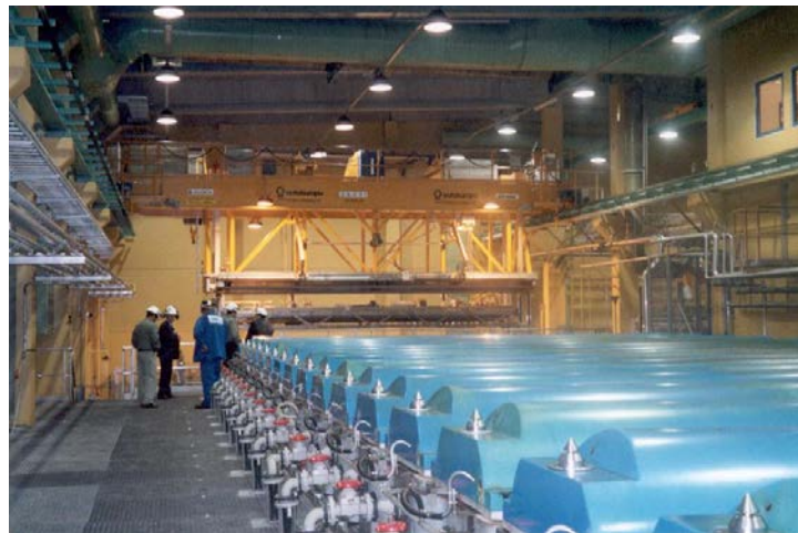
FIG. 5. SISTEMA DE LAVADO DE GASES ÁCIDOS, GENERADOS DURANTE EL PROCESO DE ELECTRÓLISIS.
