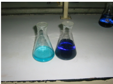
FIG. 9. FOTOGRAFÍA QUE MUESTRA EL COLOR AZUL CELESTE, AL LIXIVIAR ÓXIDOS DE Cu CON \text{H}_2\text{SO}_4 Ó (\text{NH}_4)_2\text{SO}_4 Y DE OTRA AZUL MARINO, AL FORMARSE COMPLEJOS AMONIACALES DE Cu.
