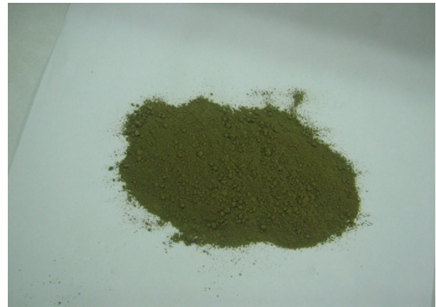
FIG. 13. FOTOGRAFÍA DE MUESTRA DEL MINERAL ÓXIDADO DE Cu PULVERIZADO, PARA GENERAR LA SOLUCIÓN RICA DE \text{Cu}-(\text{NH}_4)_2\text{SO}_4
