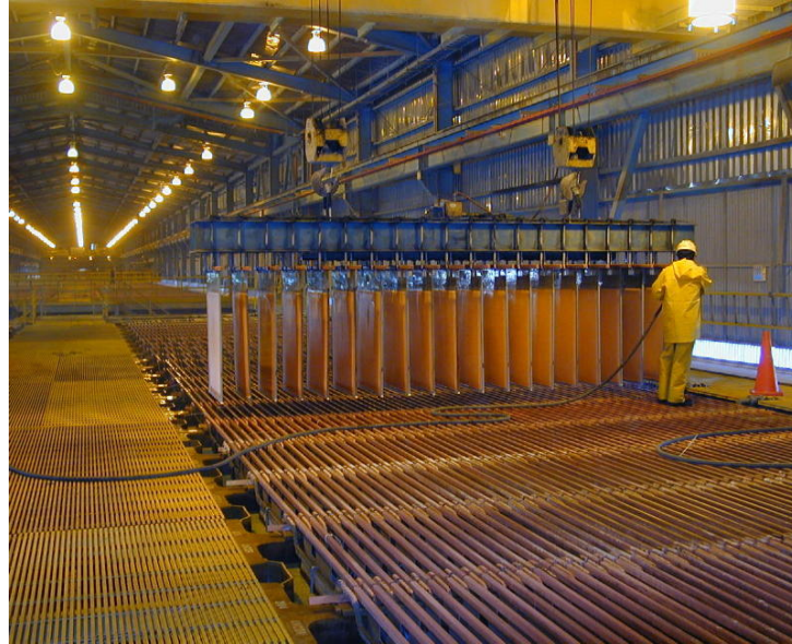
FIG. 6. FOTOGRAFÍA DEL PROCESO DE COSECHA DE CÁTODOS, CON DEPÓSITO DE Cu.
