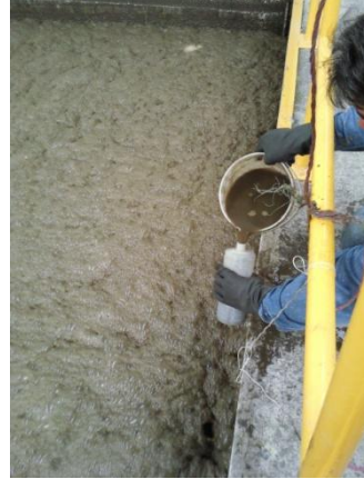
Figura 3.11 Muestreo del tanque de aireación
