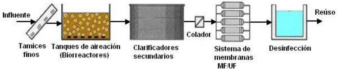
Figura 2.6 Tratamiento convencional de lodos activados con MF/UF.
