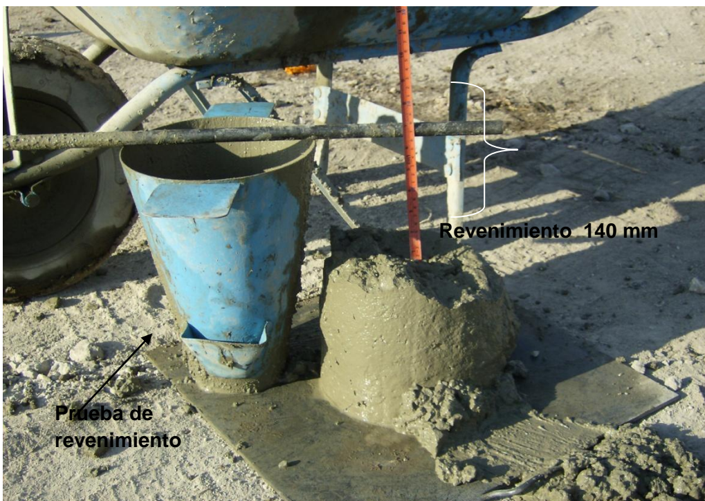
Foto 31 Prueba de revenimiento
