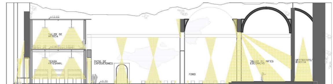
Criterio de iluminación en la nave del templo
