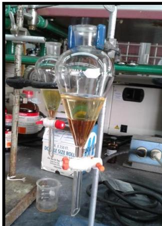
**Figura 4.2.** Fases presentes durante la separación biodiesel, fase superior biodiesel, fase inferior exceso de alcohol y aceite que no reaccionó.
