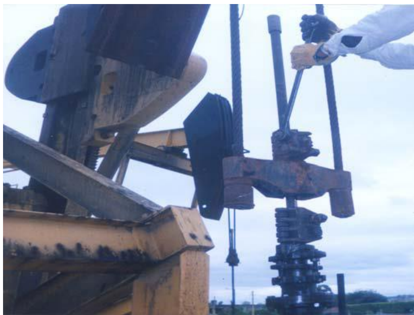
Figura 3.21. Colocación de la grampa.
