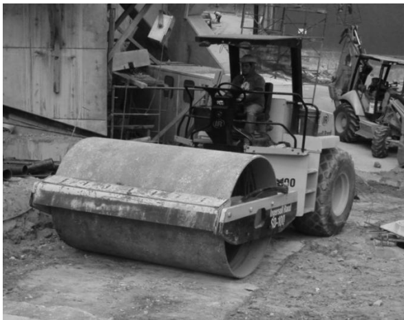
Figura. 5 cap. V Maquinaria empleada en proceso constructivo compactador
