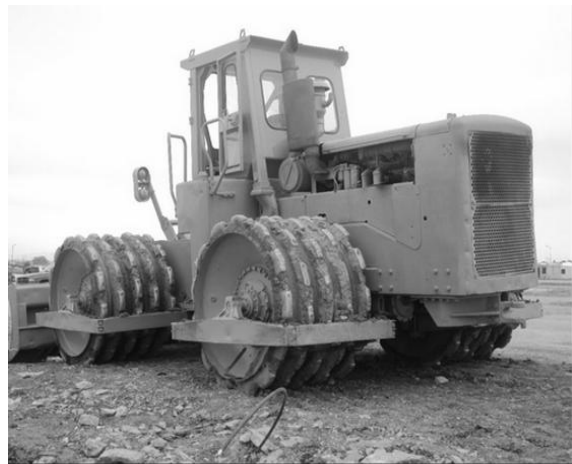
Figura. 5 cap. V Maquinaria empleada en proceso constructivo compactador
