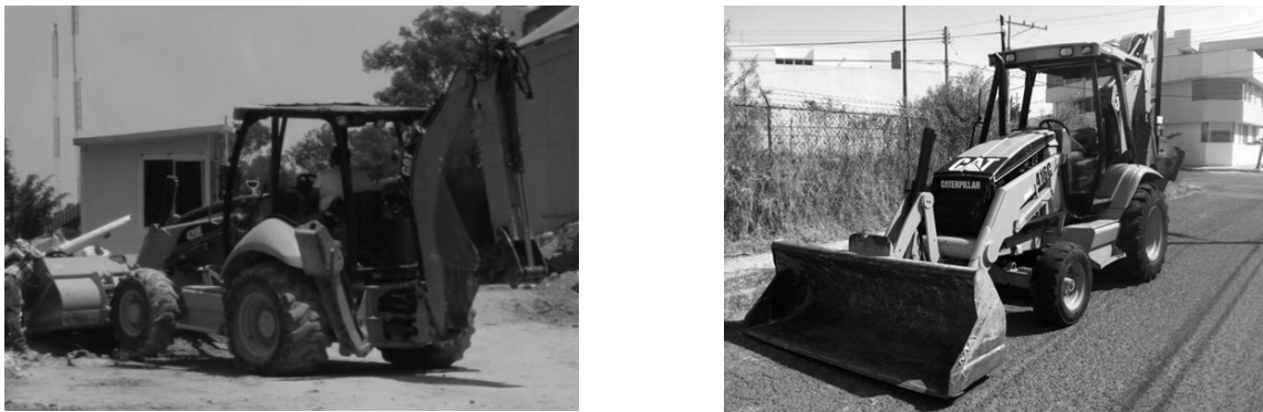
Figura. 2 cap. V Maquinaria empleada en proceso constructivo retroexcavadora
