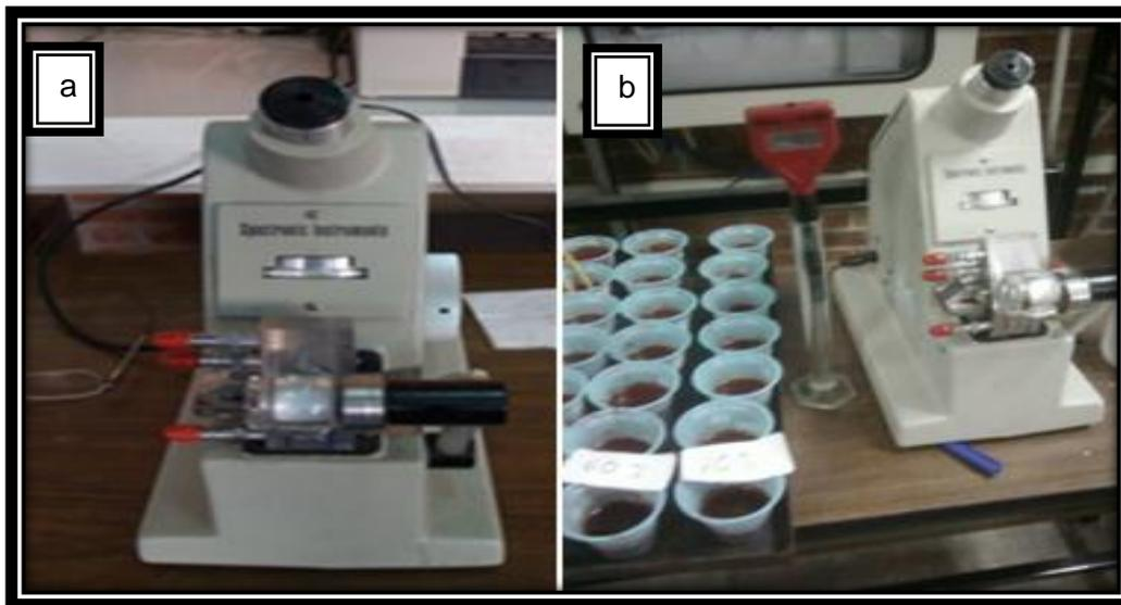
**Figura 2. 18 a) 2.18 a refractómetro; 2.18 b) refractómetro con diferentes muestras.**
