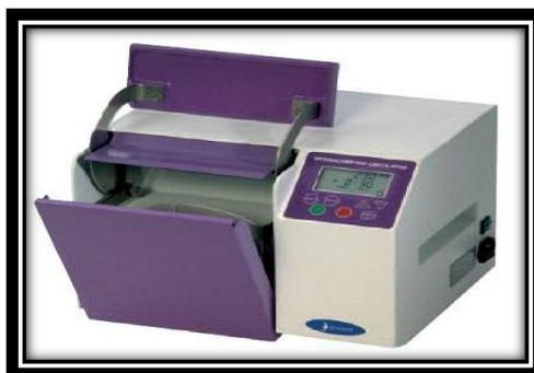
**Figura 2. 25 Homogeneizador stomacher para materia seca.**
