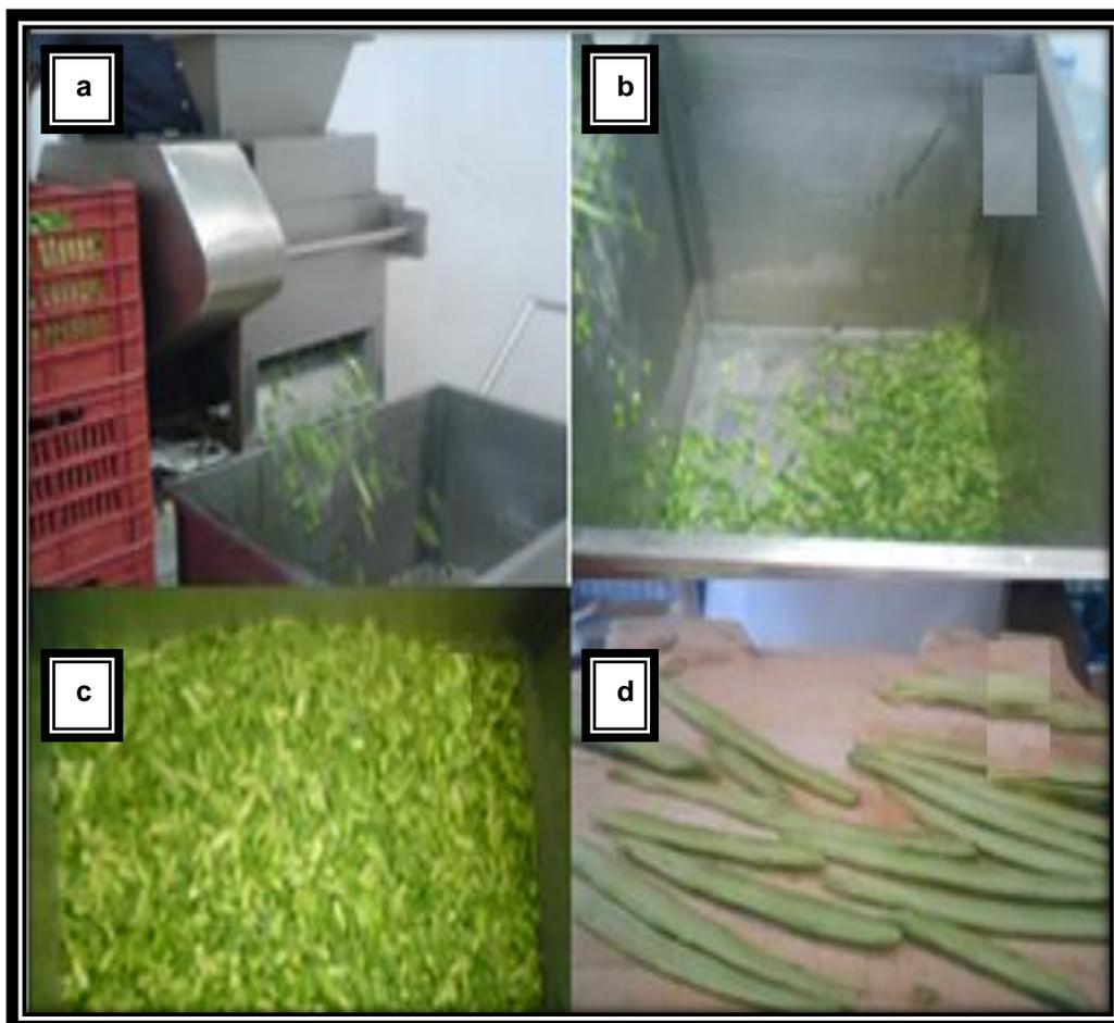
**Figura 2. 8 Troceado del nopal a) Cortadora eléctrica, b) Tina de agua con cloro, c) troceado y d) corte transversal.**
