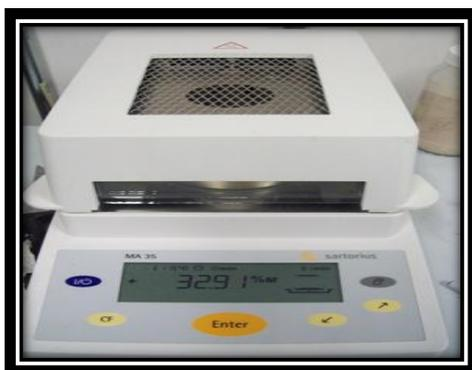
**Figura 2. 22 Termobalanza digital.**
