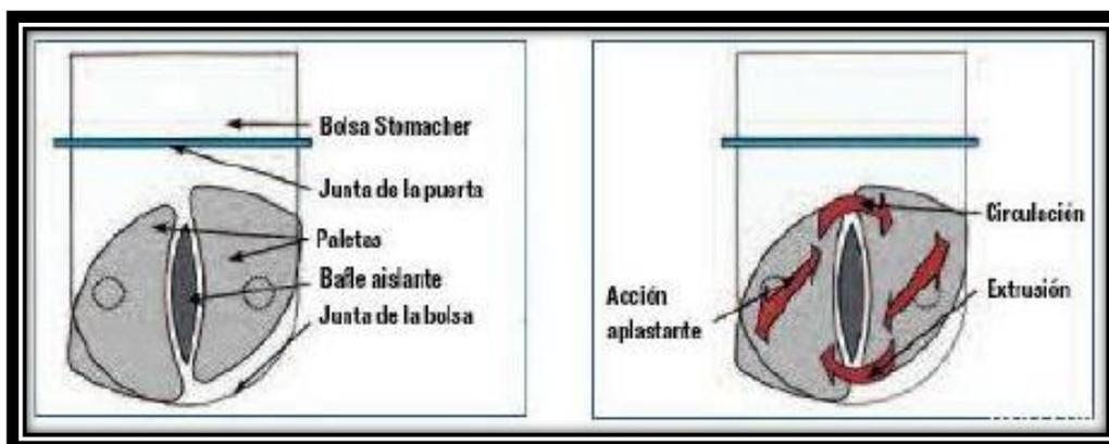
**Figura 2. 26 funcionamiento interno.**
