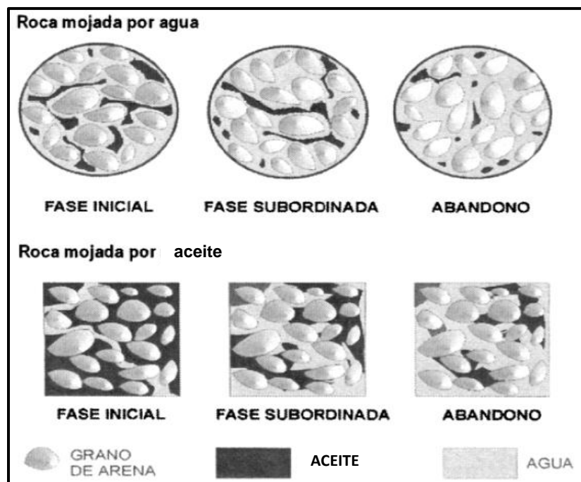
Figura. 1.12. Distribución de fluidos en una inyección de agua.
