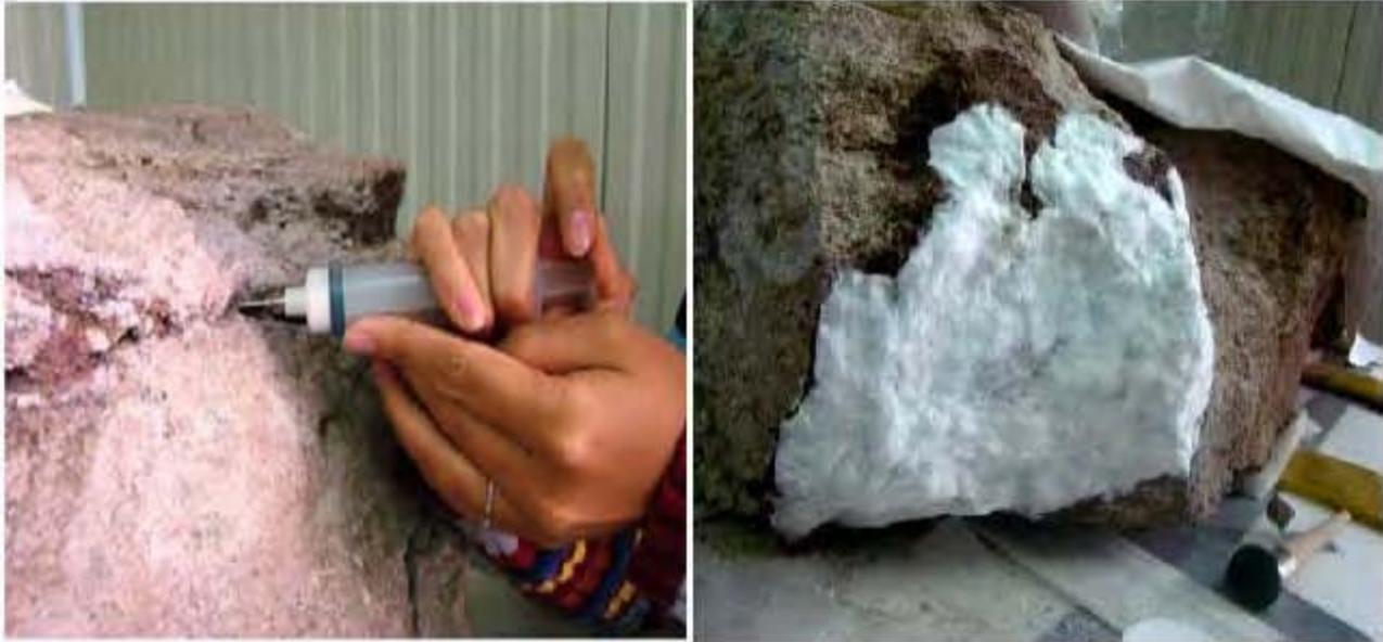
**Figura 1.6:** Método de aplicación por inyección (izq). Método de aplicación por compresas (der.) [14].
