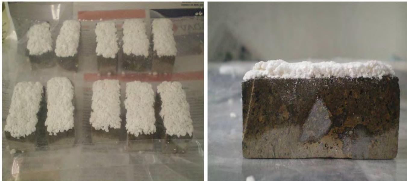
**Figura 3.7:** Proceso de consolidación de las probetas.
