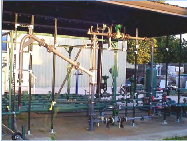
Figura 4.2 Lazo de Medición desarrollado por la Universidad de Tulsa (Kouba, et al., 1995).
