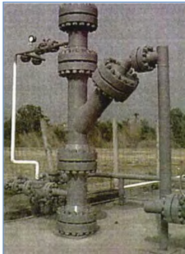
Figura 4.10 Separador GLCC para eliminación de líquido de campos de gas húmedo (Kouba et al., 2006).
