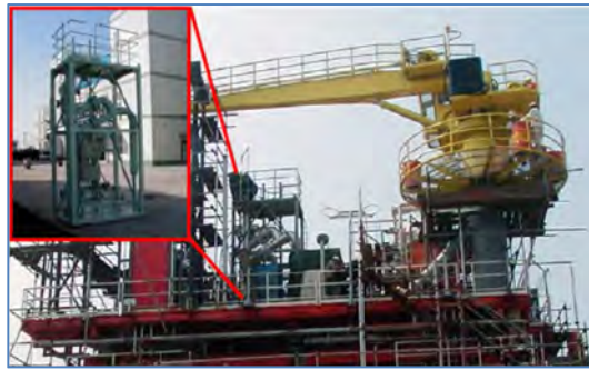
Figura 4.8 Lazo de separación-medición en plataforma para producción de gas húmedo (Kouba, et al., 2006).
