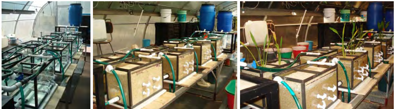
Figura 3.3 De izquierda a derecha: reactores conectados a los tanques de alimentación; reactores con arena; SE listos para operar.
