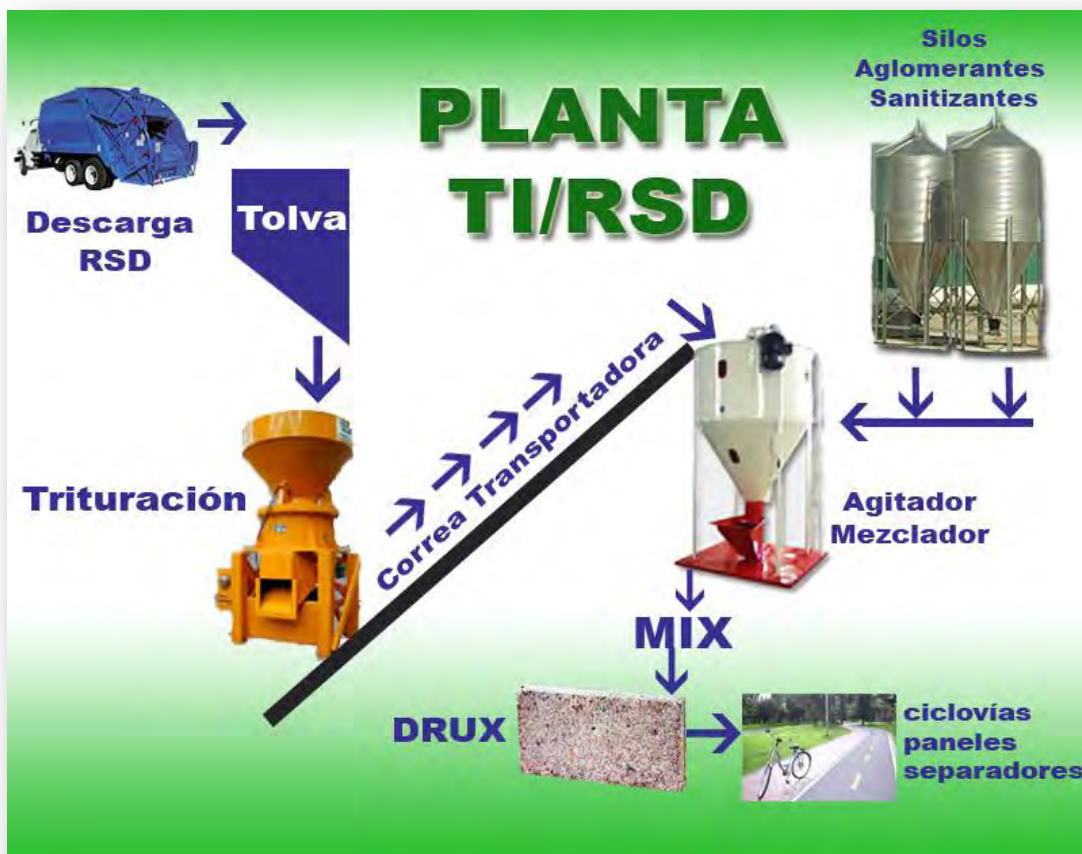
Figura 5.14 Esquema de una planta de TI/RSU
