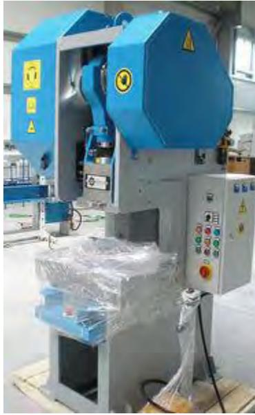
Figura 1.10. Prensa Mecánica ATM. [8]
