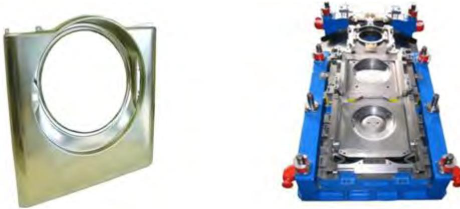
Figura 1.2 Ejemplo de pieza troquelada y troquel progresivo. [3]
