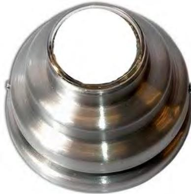
Figura 1.37. Pieza de revolución con embutido cilíndrico escalonado.
