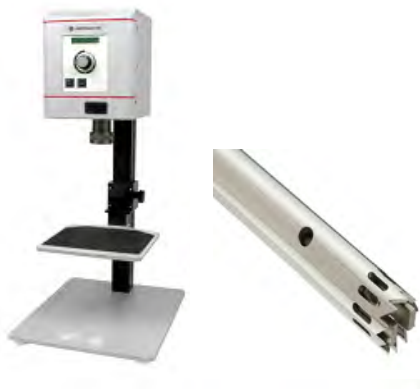
Figura 2.1 Homogeneizador “Macro Omni Es” y tipo de agitador que se utilizó para la preparación de la emulsión.
