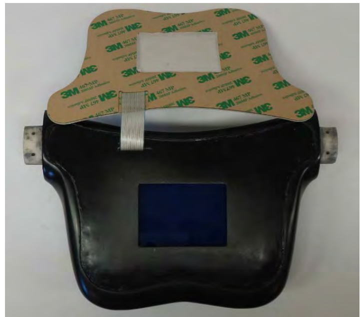
Figura 63. Instalación de teclado (IU) sobre la cubierta del volante.
