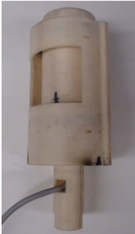
Figura 75. Ensamble final del socket para la conexión y desconexión del volante extraíble.
