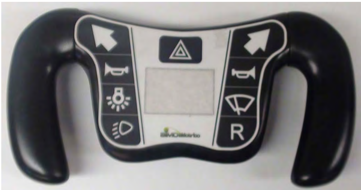
Figura 65. Ensamble final del volante.
