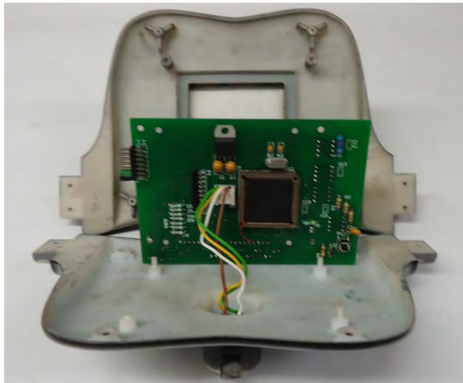
Figura 61. Instalación del MEGV en el volante del vehículo.
