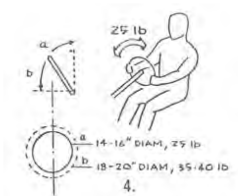
Figura 41. Fuerza aplicada sobre volante de vehículo de los años sesenta. Human engineering guide to equipment design. New York, McGraw-Hill [1963]
