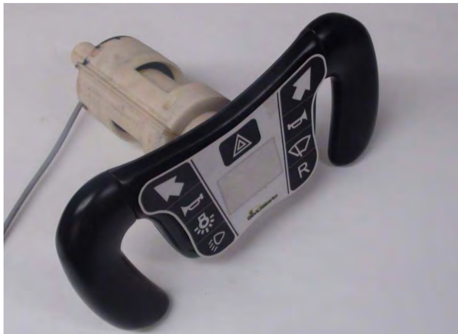
Figura 76. Prototipo final de socket y volante extraíble con controles al mando para vehículo eléctrico.
