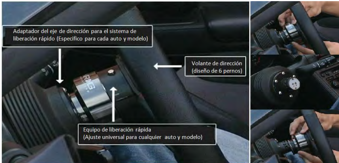
Figura 10. Adaptador comercial para hacer del volante convencional un extraíble.
