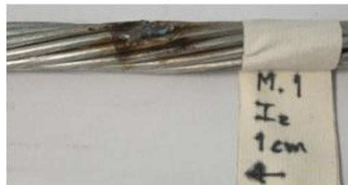
(c) Transferencia de carga 100C y 1 cm de gap
