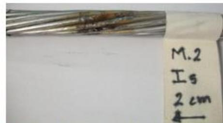
(b) Transferencia de carga 100C y 2 cm de gap
