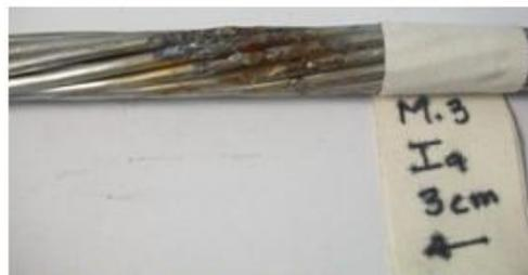
(a) Transferencia de carga 100C y 3 cm de gap
