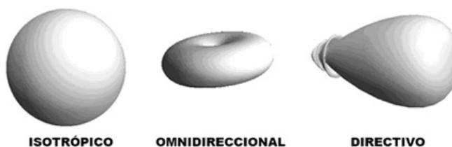
**Figura II.** Tipo de radiación (Antenas RFID, Consultado el 25 agosto de 2011, [http://www.lectoresrfid.com/Lectores\\_RFID/Antenas\\_RFID.html](http://www.lectoresrfid.com/Lectores_RFID/Antenas_RFID.html))
