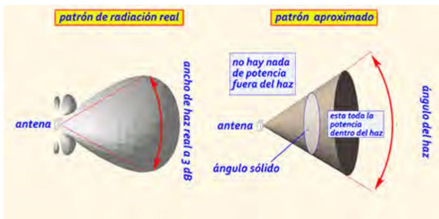
**Figura I.** Parámetros de una antena RFID (Antenas RFID, Consultado el 25 julio de 2011, [http://www.lectoresrfid.com/Lectores\\_RFID/Antenas\\_RFID.html](http://www.lectoresrfid.com/Lectores_RFID/Antenas_RFID.html))
