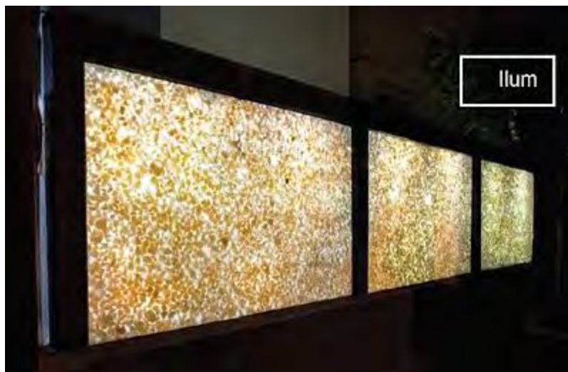
Figura 4.2 Concreto llum con agregados de conchas marinas FUENTE: Plataforma Arquitectura, 2009
