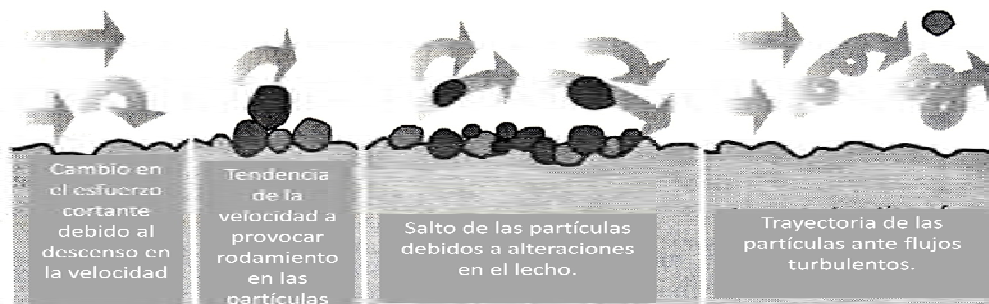
Figura 4.7 Efecto del esfuerzo cortante del agua sobre las partículas del sedimento(Ji, 2008).
