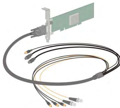
Figura 3.13 - Tarjeta Optibase MM400 son su cable
