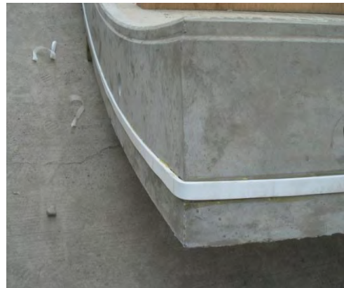
Fig. 6 Colocación de sellos en las dovela
