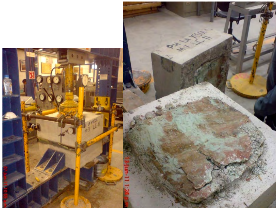
Figura 3.14. Aspecto del material arcilloso de la falla Colapso, después del ensayo de corte directo, muestra MC3-LC11
