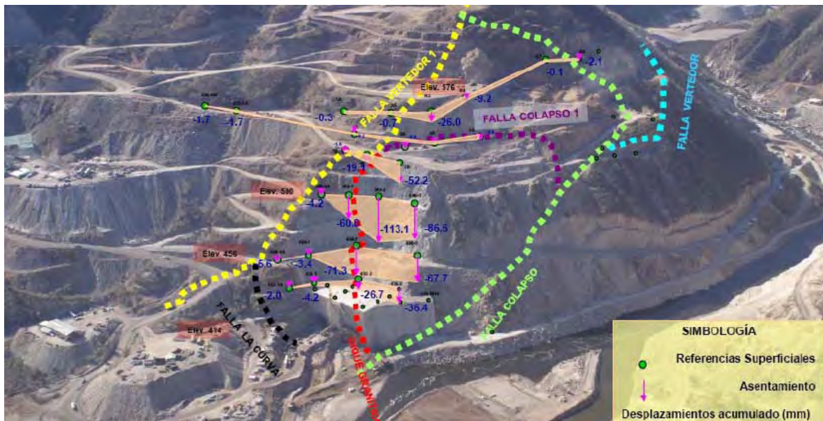
Figura 2.11 Asentamiento acumulado al mes de febrero de 2009 en referencias superficiales desde el inicio de las mediciones
