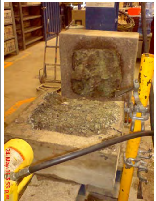
Figura 3.16. Aspecto de la brecha de falla después del ensayo de corte directo
