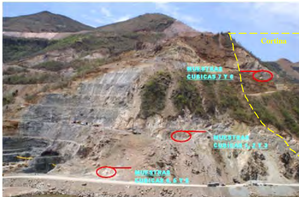
Figura 3.3. Sitios de muestreo en los afloramientos de la falla Colapso, margen izquierda. (Muestreo 2008)
