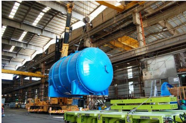
Figura 8: Planta desalinizadora por compresión de vapor fabricada por los Astilleros de Israel.
