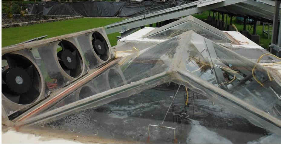
Figura 46: Destilador solar con convección forzada y sin la cubierta de acrílico.
