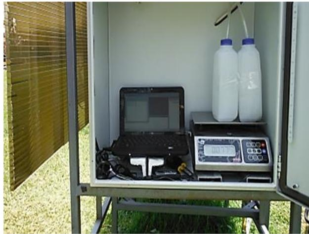
Figura 22: Vista del registro de la masa de agua destilada.
