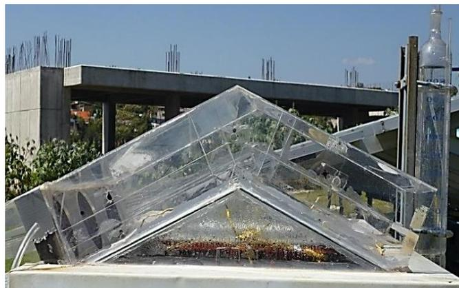
Figura 26: Vista de ventiladores y túnel de viento ubicados en el destilador con convección forzada.
