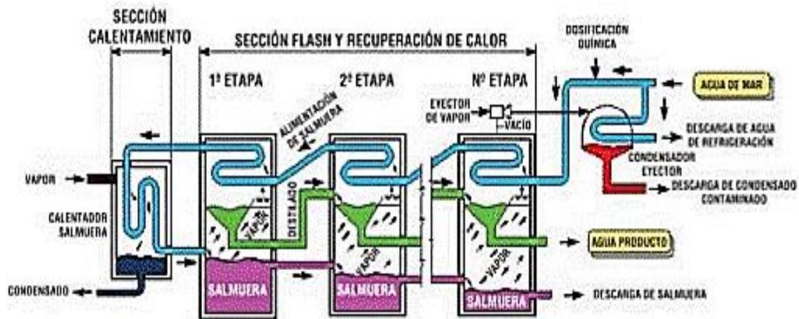
Figura 5: Diagrama de proceso de destilación súbita multietapas
