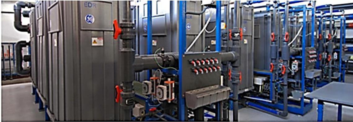
Figura 10: Planta de electrodiálisis
