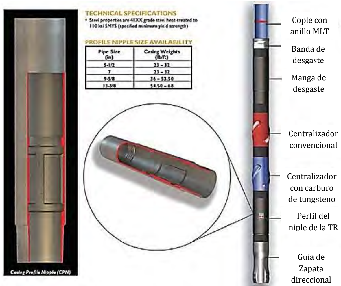
Figura 2.50 Perfil del niple de la TR
