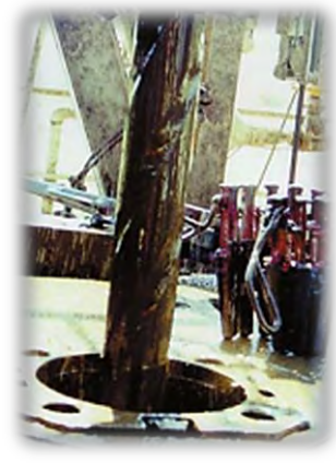
Figura 3.12 Lastrabarrenas (Drill collar) de 6 ½” helicoidales
