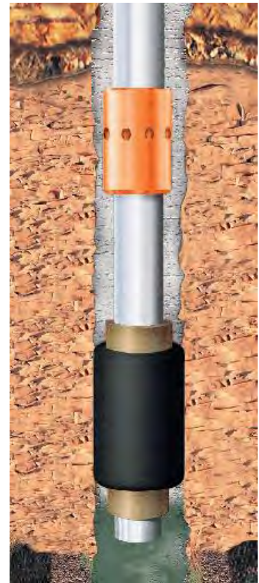
Figura 3.8 Proceso de cementación por etapas
