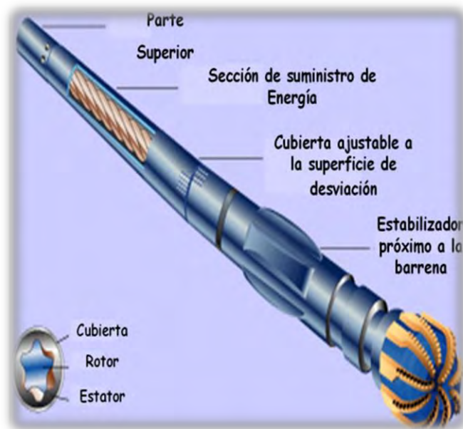
Figura 1.17 Componentes de un motor de desplazamiento positivo
