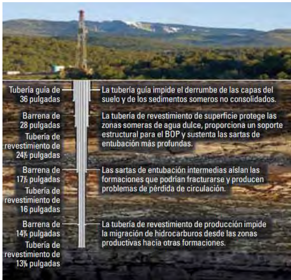
Fig. 1.1 Perfil de un pozo. (Perfil Telescópico) donde se observan diámetros cada vez más pequeños.
