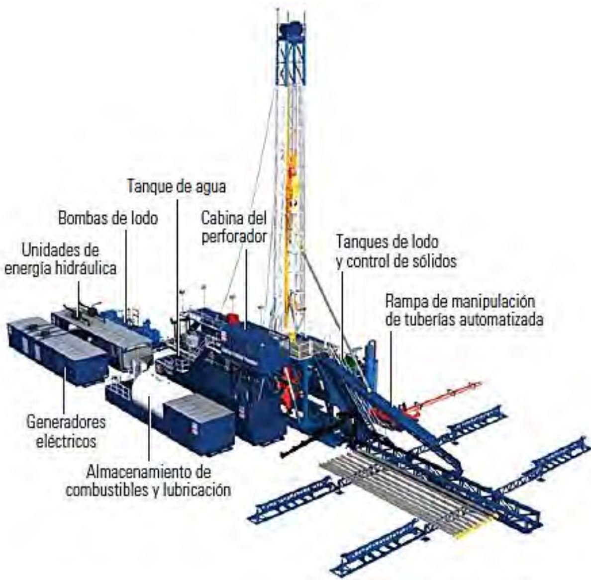
Figura 2.42 Equipo de perforación especialmente diseñado por Tesco Corporation Ltd. La plataforma también contiene el sistema de accionamiento para girar la TR, Topdrive y el cable de acero para ejecutar y recuperar las herramientas de fondo.
