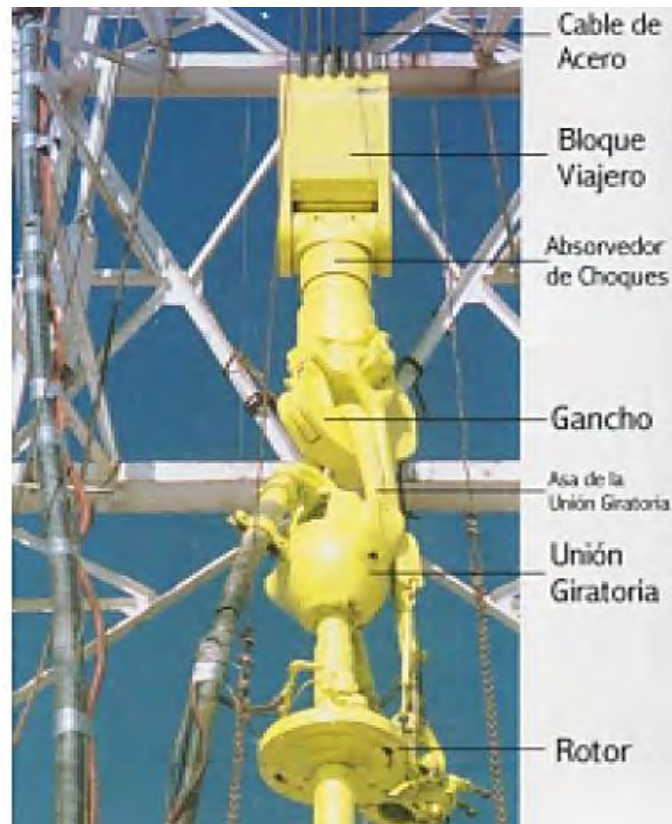
Figura 2.4 Sistema de poleas y cable de acero.
