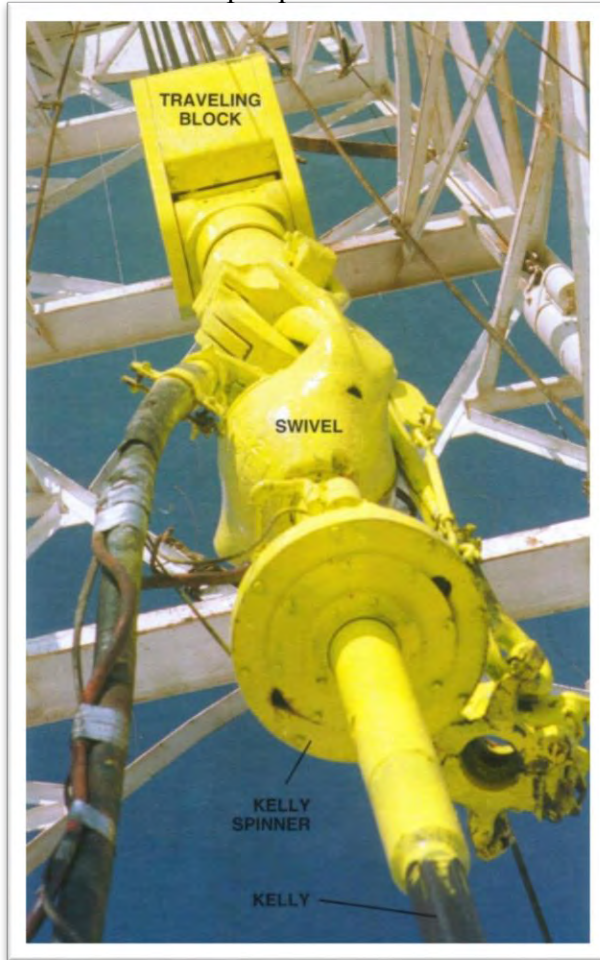
Figura 2.6 Componentes de sistema rotatorio, swivel y flecha o kelly
