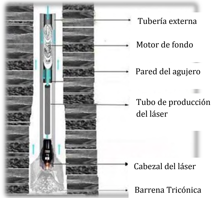
Figura 1.38 Barrena tricónica con láser con ensamble de fondo
