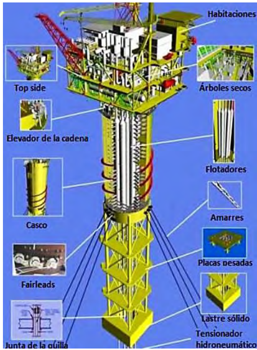
Figura 1.33 Componentes de la Boya Spar
