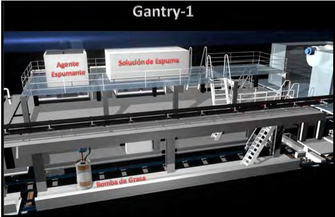
Vista lateral Derecha Gantry No.1, Tanque de agente Espumante y de solución de Espuma
