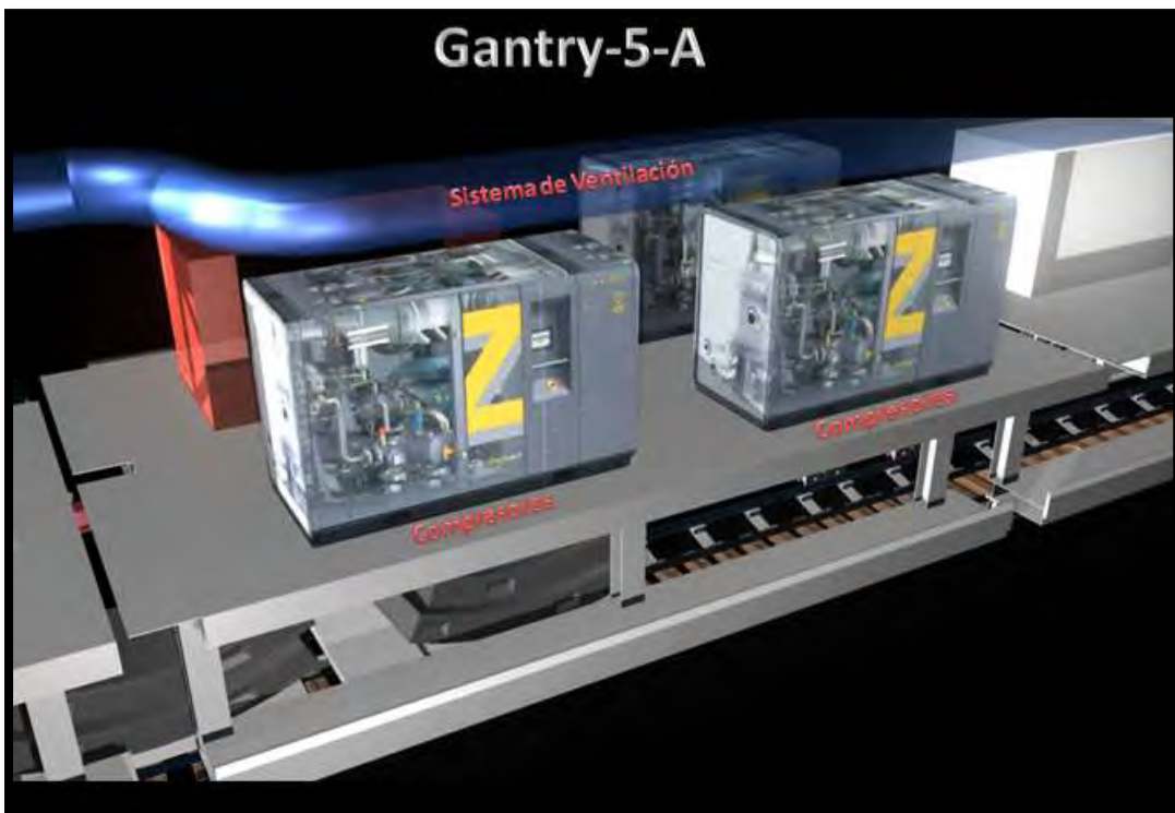
Vista lateral derecha Gantry No.5A y Sistema de Ducto de Ventilación
