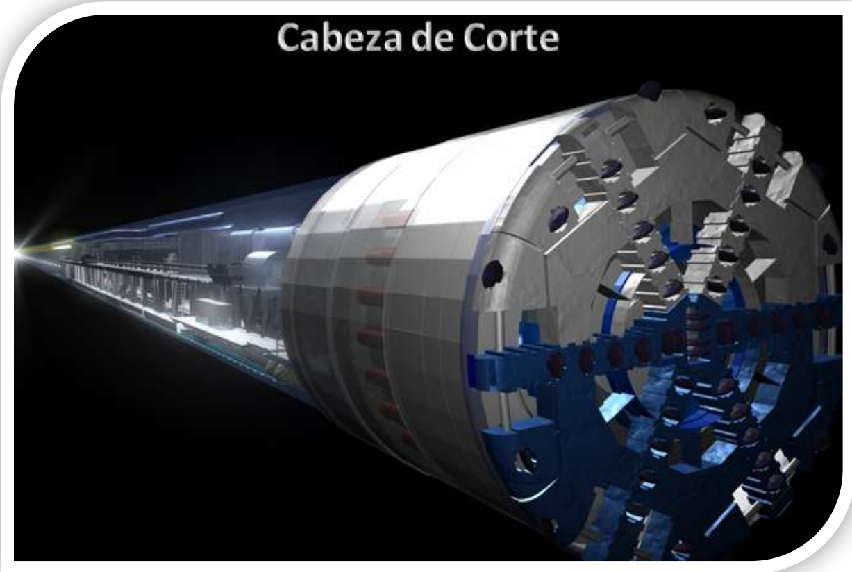
Vista Completa de TBM
