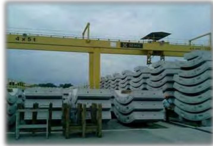
Fabricación de Dovelas y logística para su acomodo en pila en patio de dovelas.
