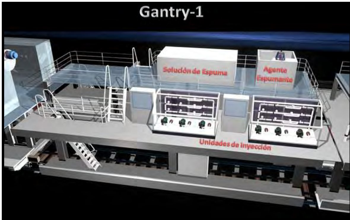
Vista lateral Izquierda Gantry No.1 y Unidades de inyección de Espuma
