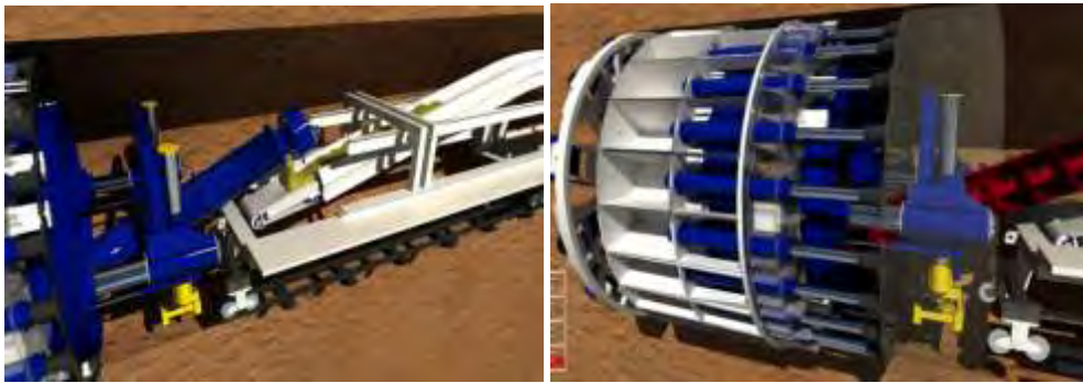
Desalojo de Material de Cámara de excavación.
