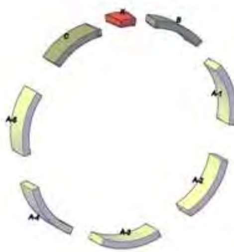
Elementos de dovelas
